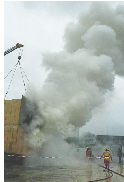
Links Vollbrand des Raumes eines Hotelzimmer-Moduls in Holz, rechts die manuell ausgelöste Löschung durch Sprinkler (Bilder des Verfassers).
