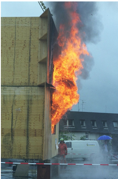
Links Vollbrand des Raumes eines Hotelzimmer-Moduls in Holz, rechts die manuell ausgelöste Löschung durch Sprinkler (Bilder des Verfassers).
